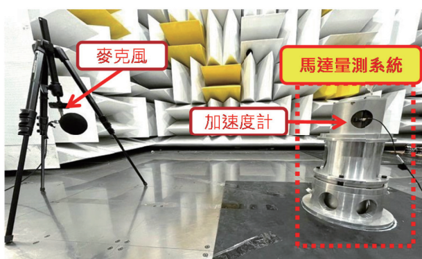
圖 10 馬達量測系統運轉狀態之實驗架設
