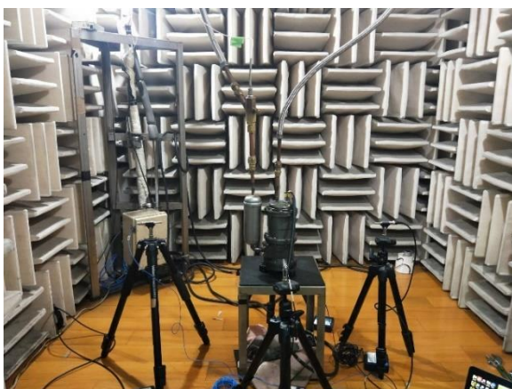
圖 3 八點噪音量測儀器架設[1]
