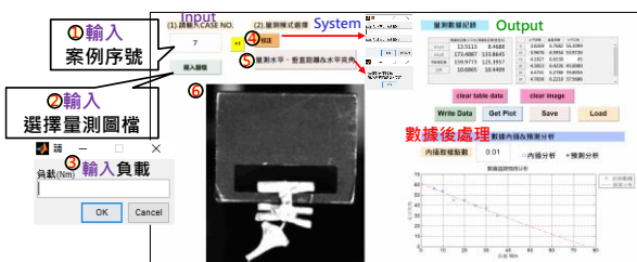
(b) 膠條變形影像之幾何參數量測模組之人機介面流程圖
