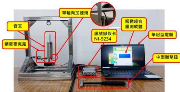
圖 5 音叉實驗模態分析儀器架設圖
