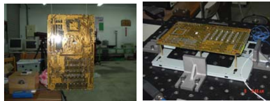
圖 6、電腦主機板之實驗模態分析實際架設圖
