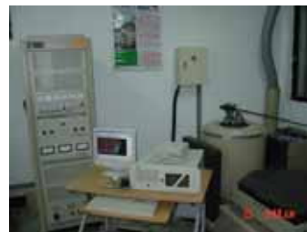
圖 8 動態實驗模態量測於振動試驗機上
