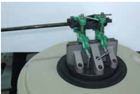
圖 6 固定一端邊界實際夾持狀態
