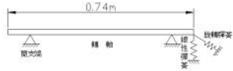
圖三、轉子系統之有限元素模型示意圖
