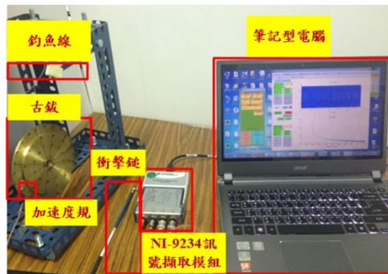
圖 6 鼓鈸結構實驗量測架設示意圖[1]
