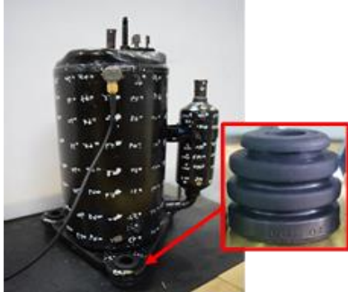
圖 1 迴轉式壓縮機之橡膠腳墊示意圖
