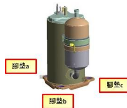
圖 11 橡膠腳墊於壓縮機位置示意圖
