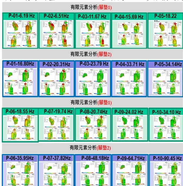
圖 15 腳墊邊界振動特性之彈簧元素分析 K 值比較圖 表 11 腳墊 1 與腳墊 2 之腳墊邊界自然頻率比較表
