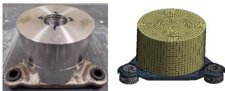
(a) 試驗平台系統 (b) 有限元素分析模型 圖 4 橡膠腳墊於三角基座板之結構示意圖
