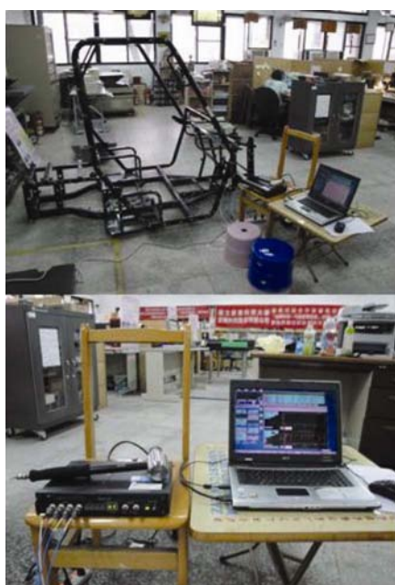
圖 3 實驗模態分析之設備架設圖 [11]
