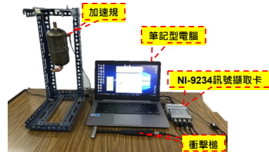
(b) 實驗架設示意圖
