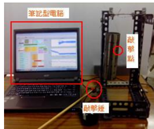
圖 8 不鏽鋼管聲音量測實驗儀器架設圖
