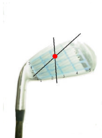
圖五、鐵桿球頭實體甜蜜區分佈
