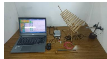
圖 5 實驗模態分析量測儀器架設圖
