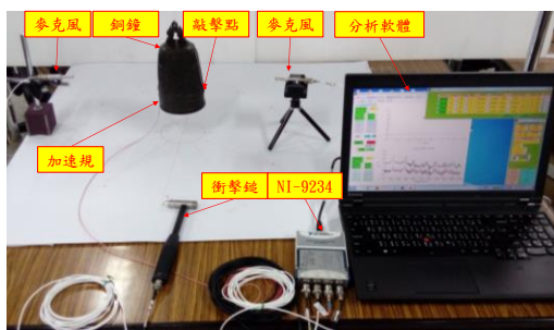
圖 2 銅鐘聲音量測之實驗儀器架設圖
