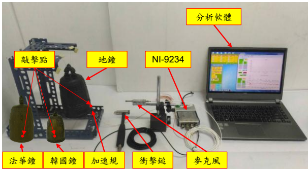
圖三：不同銅鐘之量測儀器架設圖
