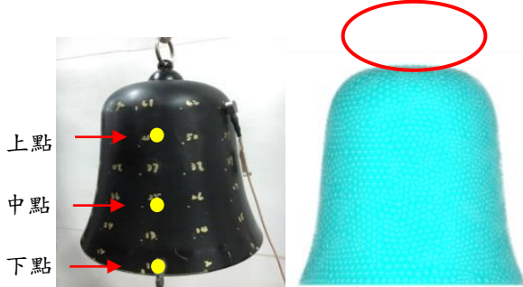
圖 1、銅鐘實體結構與敲擊點示意圖
