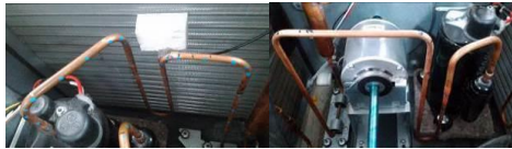
(a)吸入口銅管 (b)吐出口銅管 圖 1 壓縮機冷媒輸送路徑結構實體圖
