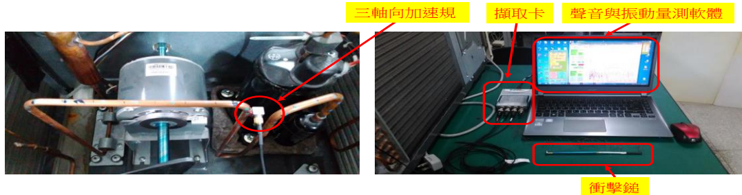
圖 15 吐出口銅管之實驗量測架設圖
