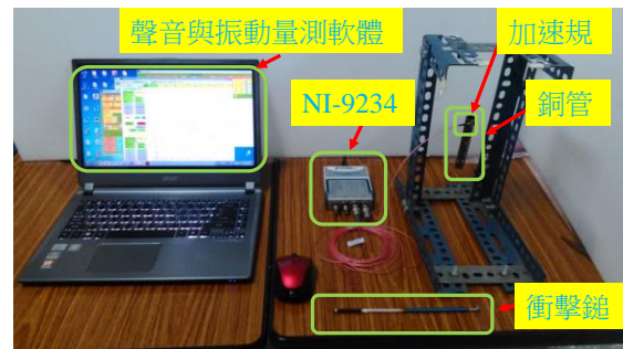
圖 6 銅管之實驗量測架設圖
