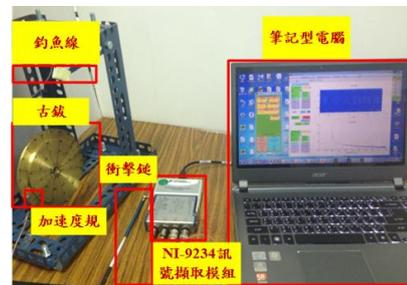
圖5：結構系統實驗架構圖
