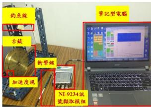
圖8: 空氣結構耦合系統實驗架構圖
