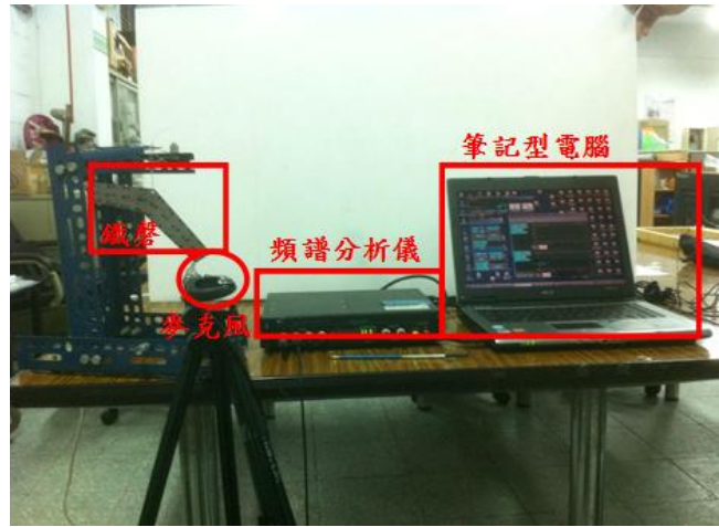
圖 6 聲場實驗儀器架設圖
