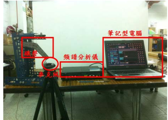
圖 5、鐵磬之實驗架構示意圖
