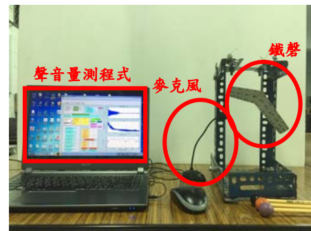
圖9、實際自由邊界下之聲音量測儀器架設圖
