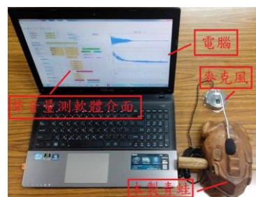
圖 4、聲音量測軟體實驗架構圖
