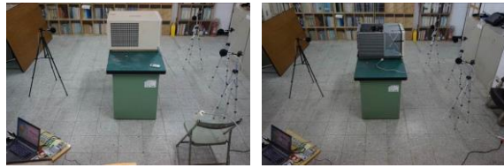
(a)有外殼 (b)無外殼 圖 6 冷氣機有/無外殼之實驗量測圖
