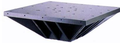
圖7. 振動試驗機垂直輔助平台實體圖
