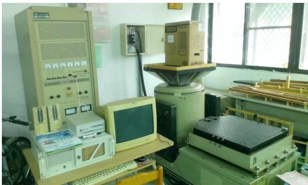
圖4. 電磁式高頻振動試驗機
