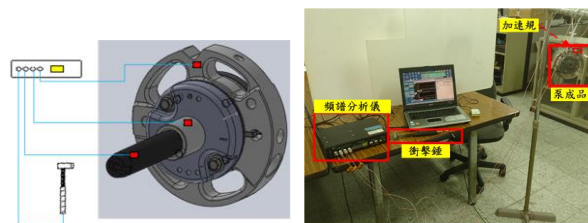
(a) 實驗架構模擬示意圖 (b) 實驗架設圖 圖 3 泵組件實驗架構示意圖
