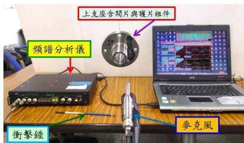
圖 4 上支座含閥片與護片組件實驗架設圖
