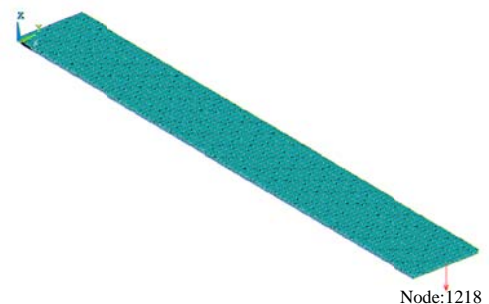
圖 4、懸臂樑之有限元素示意圖[2]
