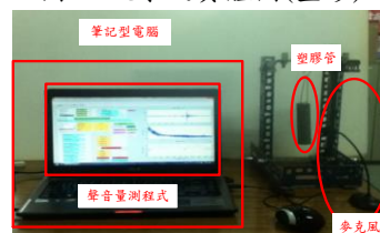
圖 8 塑膠管聲音量測實驗儀器架設圖
