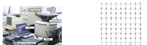
(a) 實驗儀器架設圖 (b) 量測規劃點 圖 6 振動平台實驗量測規劃
