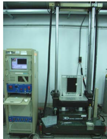
圖 1 擊測試時待測物擺放位置示意圖
