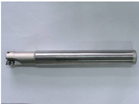
圖 2 可拋棄刀片之端銑刀之實際結構圖
