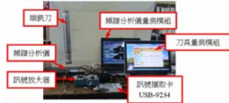
圖 20 刀具量測模組與頻譜分析儀同步量測示意圖
