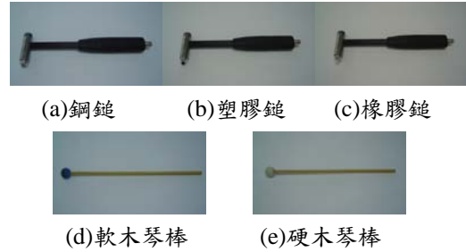
圖 3、不同材質的衝擊錘對照圖
