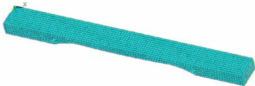
圖 1、木琴條有限元素模型示意圖
