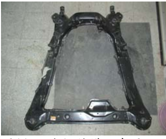
圖(a) 口字樑結構示意圖 圖(b) 有限元素之模型 圖 1、前懸吊之口字樑結構(如圖 a)和有限元素模型(如圖 b)
