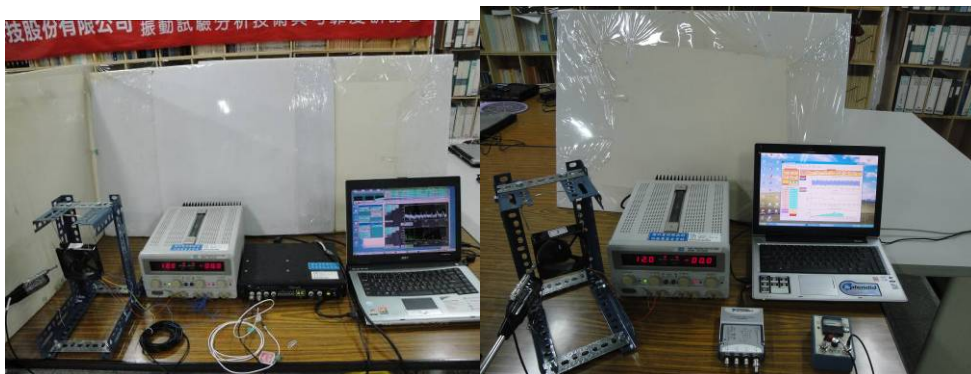
圖 21、風扇噪音量測模組與頻譜分析儀同步量測示意圖
