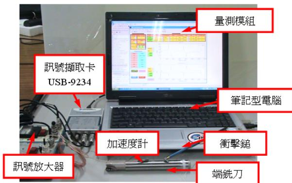
圖 2、儀器架設示意圖
