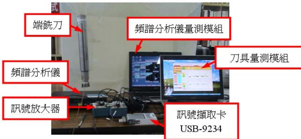
圖 20、刀具量測模組與頻譜分析儀同步量測示意圖
