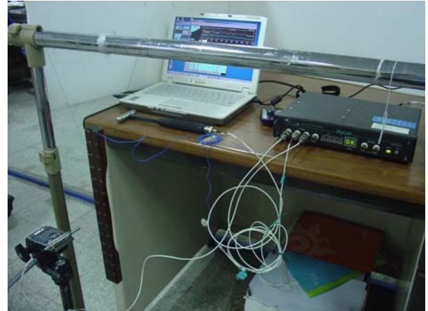
圖 4 實驗模態分析設備實際架設圖
