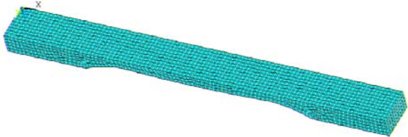
圖 2 木琴條自由邊界之有限元素模型示意圖
