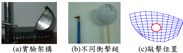
圖 5 球頭振動模態與聲音量測架構圖
