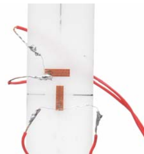
圖 4、黏貼應變規與接上導線之試片圖
