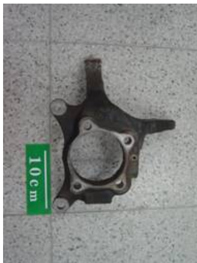
圖 3 前懸轉向節實體模型 [2]
