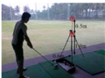
圖 4.室外擊球聲音量測示意圖
