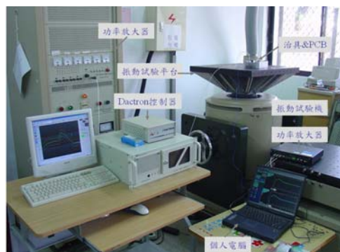
圖 8 隨機振動實驗示意圖
