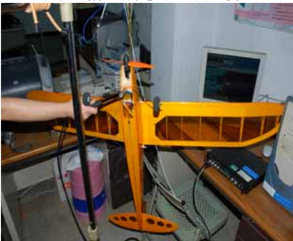
圖 4. 飛機模態測試架構圖
