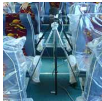
圖三、噪音計量測位置
