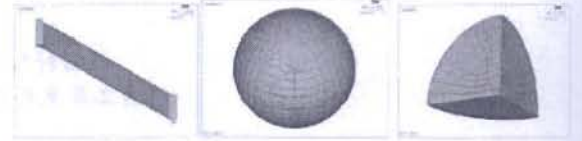
(a) 素材試片 (b) 高爾夫球結構 (c) 1/8 球體 圖 3. 高爾夫球素材與高爾夫球之有限元素模型
