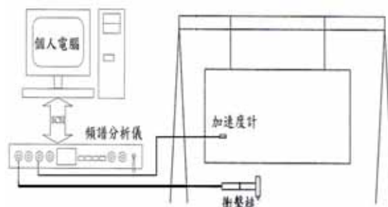
圖 5 實驗模態儀器設備架構
