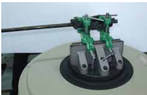
圖 6 固定一端邊界實際夾持狀態
