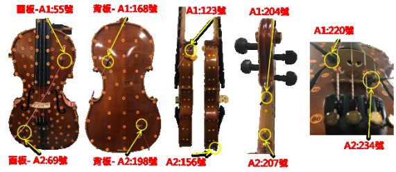
圖 3 有琴弦張力之小提琴各部件量測點示意圖
