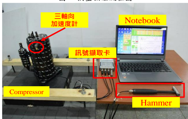
圖 2 壓縮機實驗量測架設圖
